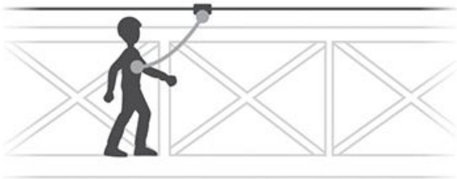
ABSORBICA-I jednostruki sigurnosni komplet dizajniran za zaštitu na horizontalnim sigurnosnim linijama ili na povišenoj platformi.
